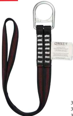
Adaptador de anclaje con diseño fácil de usar, liviano y de alta resistencia fabricado en reata tubular 25 mm, en largo según referencia 180cm (71 pulgadas) 150cm (59 pulgadas) 120cm (47 pulgadas) 100 cm (39 pulgadas) 80 cm,(32 pulgadas), 60 cm (24 pulgadas), con argolla tipo "D" en un extremo proporcionando compatibilidad al anclaje, se adapta a una estructura con un diámetro máximo de 7,6 cm (3 pulgadas).
