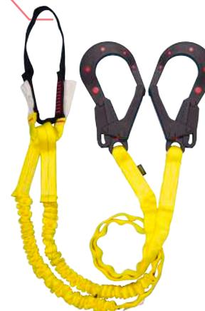
Eslinga dialéctica de detención de caída en reata tubular con sistema interno de absorción de energía, se usa para trabajos apoyados sobre las piernas con posibilidad de tener las manos libres, útil para cualquier trabajo en alturas superior a 6 metros, cuenta con un loop y un gancho de 20 mm de apertura de doble seguro en acero recubierto, automáticos o accionamiento con dos movimientos.
