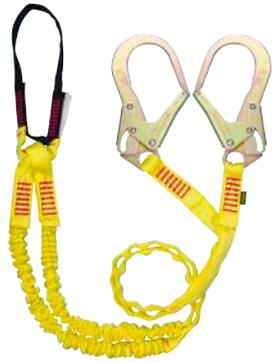
Eslinga tipo Y dieléctrica para detención de caídas en reata tubular con sistema interno de absorción de energía útil para cualquier trabajo en altura superior a 6 metros en un extremo lleva un loop para anclarse al arnés y al otro extremo se puede disponer de gancho de seguridad compatibles tipo C.
