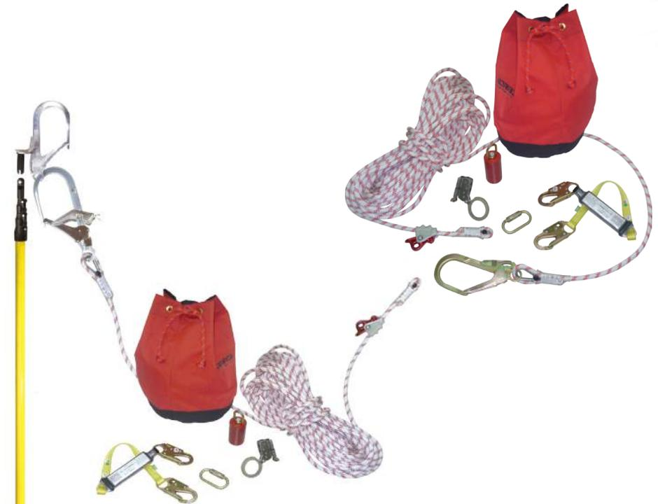
Es un sistema de protección de caídas que permite al usuario desplazamiento vertical en ambos sentidos estando siempre unido a la cuerda por medio de un interruptor de caídas (rope grab) el cual se activa por aceleración de una caída libre
