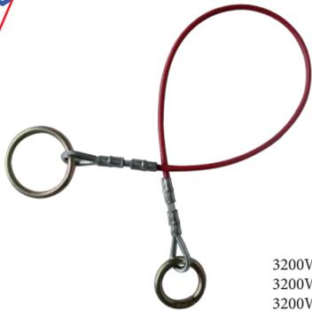
Estrangulador de postes de diferentes medidas especial para soldadores y superficies cortantes, largo según referencia 180cm (71 pulgadas) 150cm (59 pulgadas) 120cm (47 pulgadas) 100 cm (39 pulgadas), fabricada en cable de acero termosellada, con argolla en "O" en acero a los extremos proporcionando un punto de conexión compatible para la eslinga o anticaídas.
