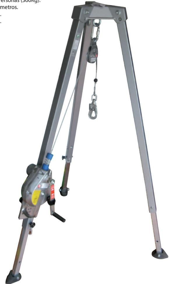
Equipo especial para realizar trabajos en espacios confinados, consta de tres patas telescópicas que se bloquean automáticamente en la posición de trabajo y permiten graduar la altura desde 1.44m a 2.44m, situados en la parte superior del equipo, tiene 2 ojos de carga los cuales permiten enganchar poleas y un sin número de equipos para realizar trabajos, operaciones de rescate, subir y bajar cargas no superiores a 200Kg.
