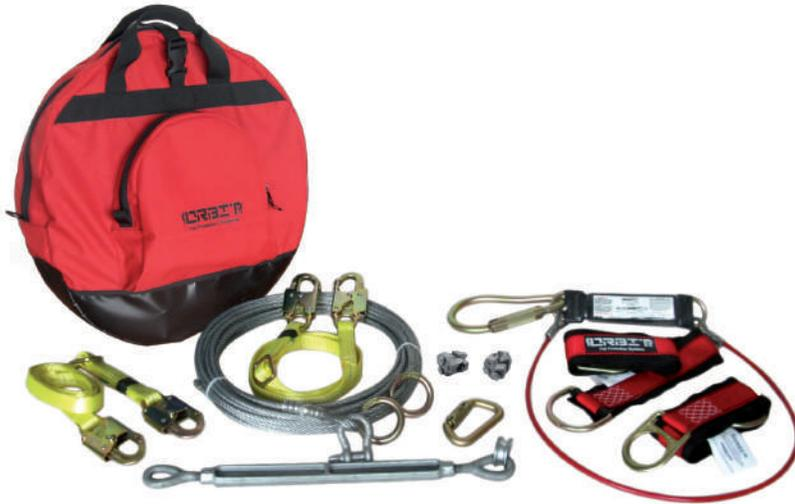
Las líneas de vida horizontales son un sistema de protección contracaídas, que permite al usuario desplazarse de forma horizontal a través del cable estando siempre unido a esta por medio de un absorbedor de energía, el cual se activa en caída.
