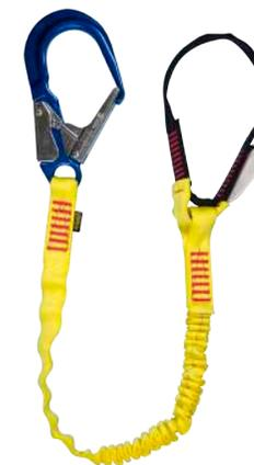
Eslinga dialéctica de detención de caída en reata tubular con sistema interno de absorción de energía, se usa para trabajos apoyados sobre las piernas con posibilidad de tener las manos libres, útil para cualquier trabajo en alturas superior a 6 metros, cuenta con un loop y un gancho de 65 mm de apertura de doble seguro en acero recubierto, automáticos o accionamiento con dos movimientos.
