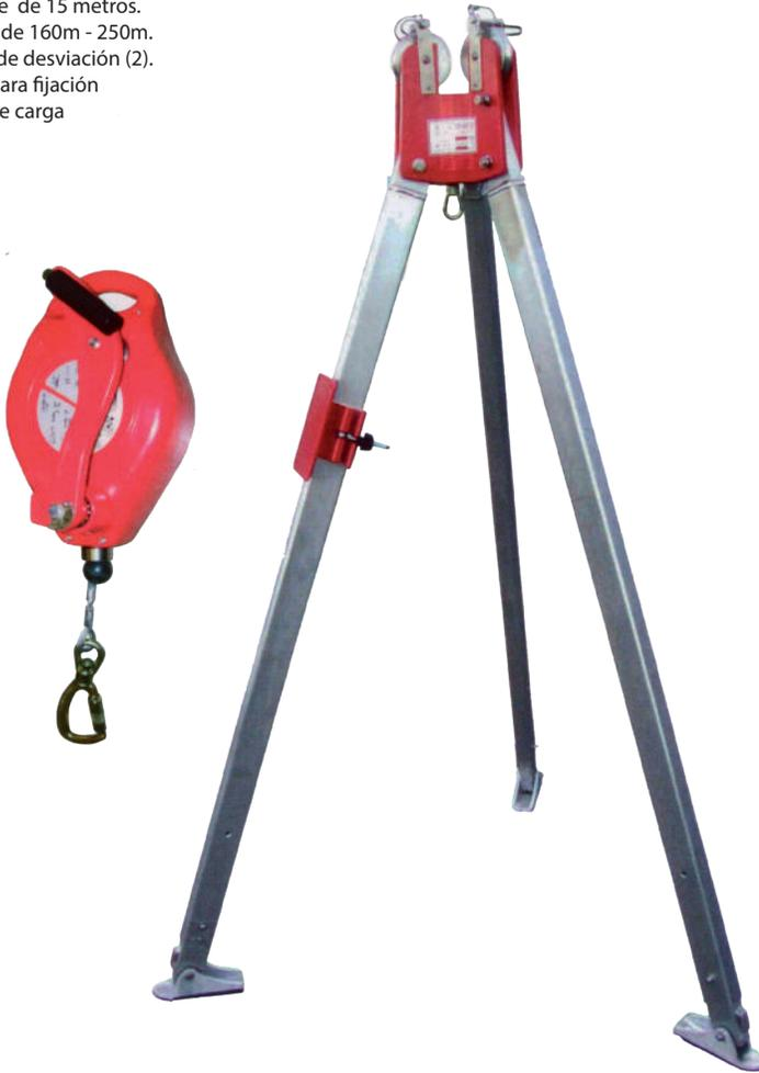
Equipo especial para realizar trabajos en espacios confinados, consta de tres patas telescópicas que se bloquean automáticamente en la posición de trabajo y permiten graduar la altura desde 1.60m a 2.50m, situados en la parte superior del equipo, se encuentran dos poleas incorporadas que le permite instalar el winche de trabajo y seguridad, además 2 ojos de carga los cuales permiten realizar trabajos en espacios confinados, operaciones de rescate, subir y bajar cargas no superiores a 360Kg.
