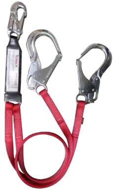
Eslinga de detención a caídas de dos brazos tipo Y en reata se usa para trabajos apoyado sobre las piernas, posibilidad de anclarse a dos estructuras simultáneamente y de tener las manos libres, cuenta con dos ganchos de 65 mm de apertura y uno de 20 mm de apertura, que permite el anclaje a estructuras entre 50 y 70 mm, los ganchos son de doble seguro en acero o aluminio, automáticos o accionamiento con dos movimientos.
